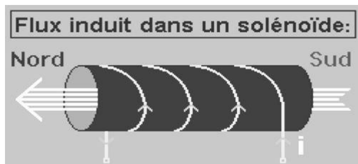
Figure I.10 Flux induit de moteur pas à pas.
