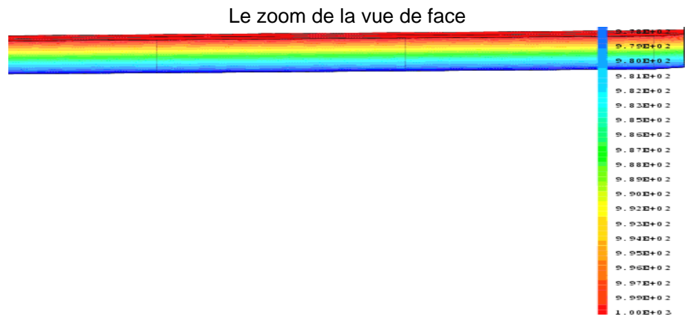
Figure III-69 CHAMP DE TEMPETATURE LE LONG DE L'EPAISSEUR avec dt= 25°C (1000° c _950°c)
