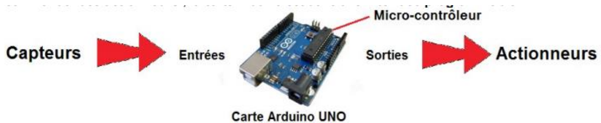
Figure 3. 2. La carte Arduino (entrées-composants-sorties)(Fréou, 2023)
