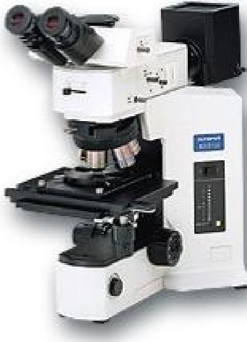
Figure III.1: Microscope optique OLYMPUS BX51M (LPTTSM Université de Constantine)
