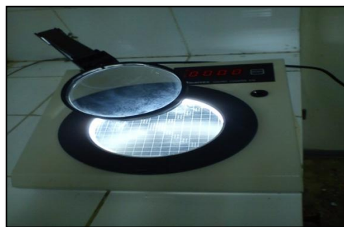
Figure 22 : Photographie du compteur de colonies.
