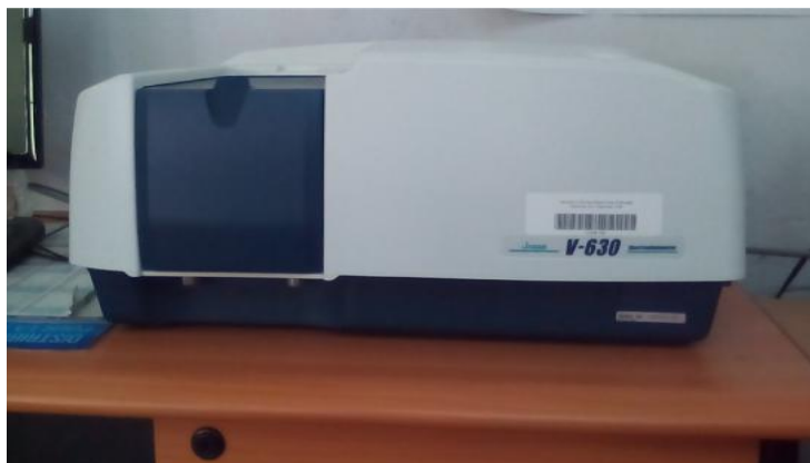
Figure.III.18. Présentation du spectrophotomètre UV-Visible de type JASCO V-630 (Laboratoire composants actifs et matériaux, Univ. De Oum El Bouaghi).
