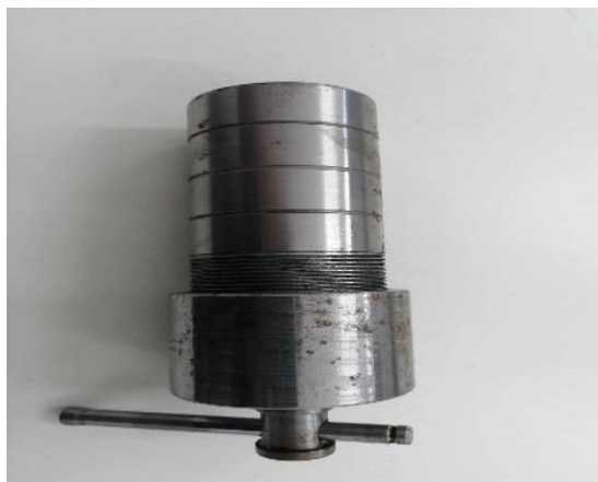
Figure III.7 : Photographie d'un réacteur autoclave de synthèse hydrothermale (a) : Téflon et (b), (c), (d) : autoclave. (Laboratoire composants actifs et matériaux, Univ. De Oum El Bouaghi).
