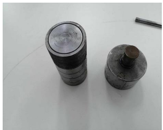
Figure III.7 : Photographie d'un réacteur autoclave de synthèse hydrothermale (a) : Téflon et (b), (c), (d) : autoclave. (Laboratoire composants actifs et matériaux, Univ. De Oum El Bouaghi).
