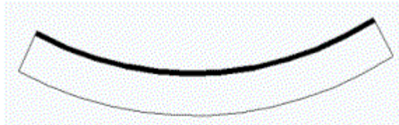
Fig.1.13 Contrainte de tension, schéma conceptuel. Le film se veut 'plus petit' que le substrat pour s'y adapter parce qu'il a été 'tendu' [108]
