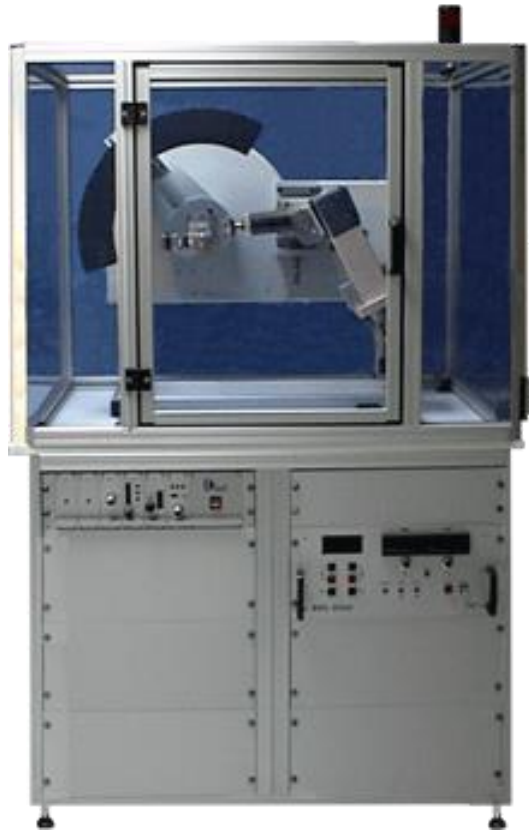
Fig. II.7 Diffractomètre Inel, muni du détecteur courbe (le tube est à droite et le détecteur à gauche)
