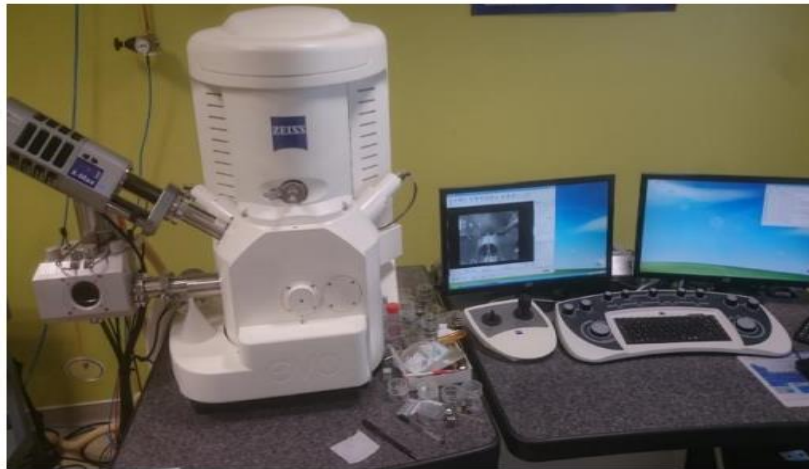
Fig.III.9 Photo du MEB à effet de champ « ZEISS EVO LS10 »
