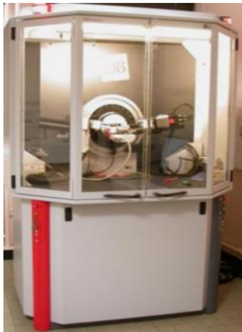
Fig.III.4 Diffractomètre BRUKER-AXS type D8
