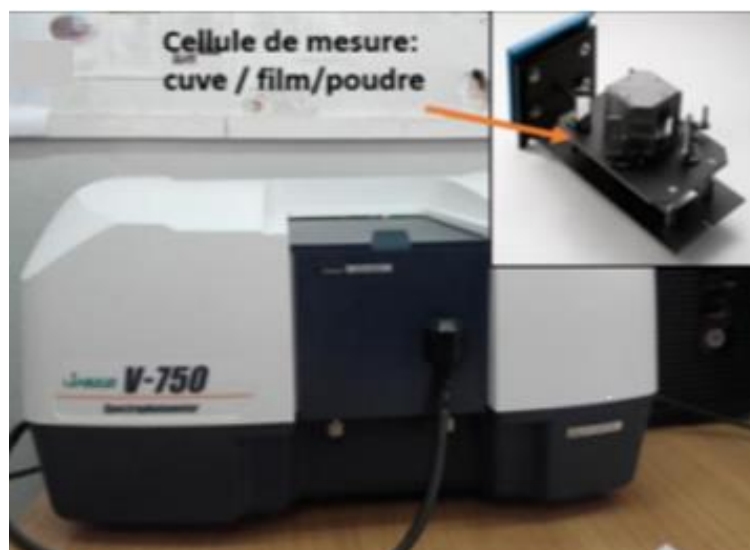
Fig.III.13 Spectrophotomètre UV-Visible de type JASCO V-750
