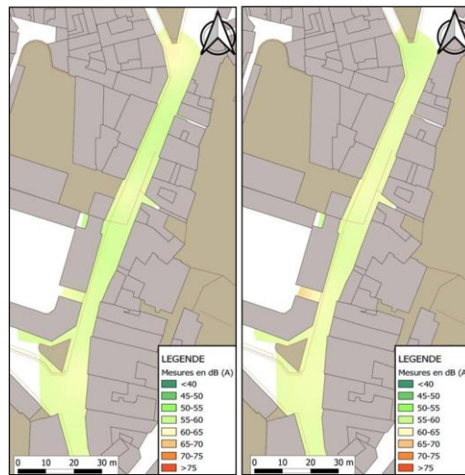
Figure 141: Cartographie des bruits des périodes diurne et soirée de la continuité de la rue Fatima . Source K. Ikni 2019.
