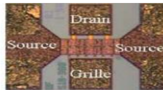
Figure (I-23): Photographie du MESFET issu de la fonderie TRIQUINT [18].
