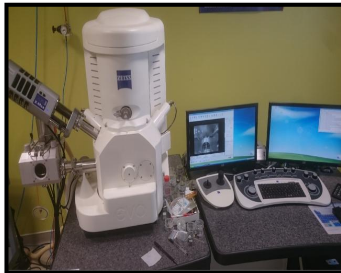
Fig.III.6 Photos du EDX « ZEISS EVO LS10 » (Université d'Angers, France).
