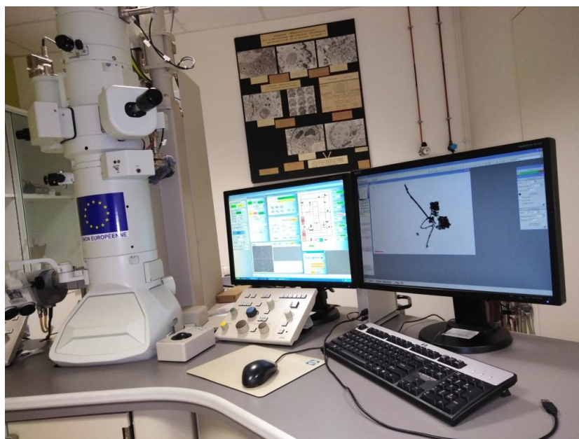
Fig.III.7 Photos du MET « ZEISS euro-350 » (Université d'Angers, France)
