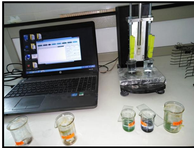
Fig.II.19 Dispositif de dip-coating assisté par micro-processeur
