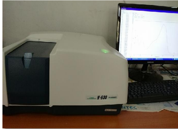
Fig.III.10 Spectrophotomètre UV-Visible de type JASCO V-630
