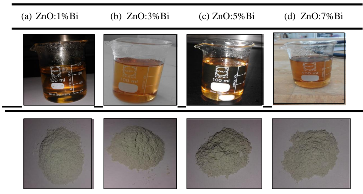
Fig.II.10 Elaboration des nanopoudres de ZnO pur et dopé par Bi (a) 1%, (b) 3%,(c) 5% et (d) 7%.
