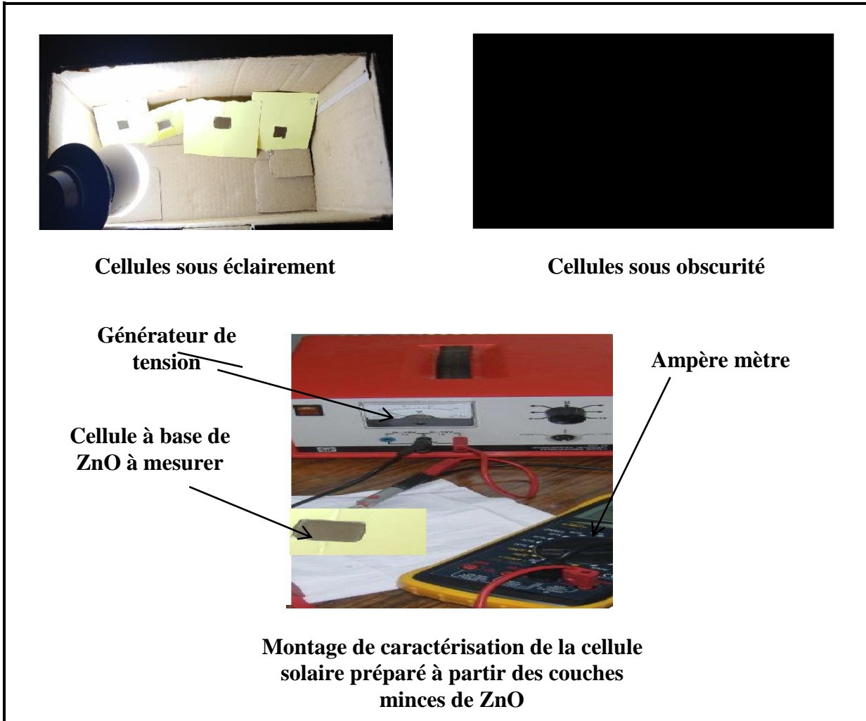
Fig.II.20 Différentes étapes de la réalisation d'une cellule solaire de ZnO pure et dopé au Cr (1.5%-3.5%)
