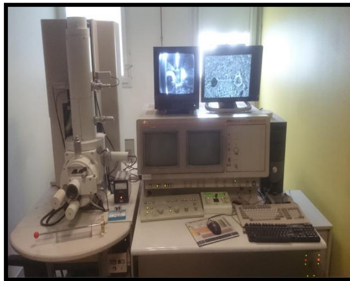
Fig.III.4 Photo du MEB à effet de champ « JEOL JSM 6301F » (Université d'Angers, France)
