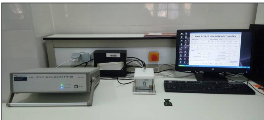
Fig.III.15 Montage expérimental pour les mesures de l'effet Hall de type HMS-3000.
