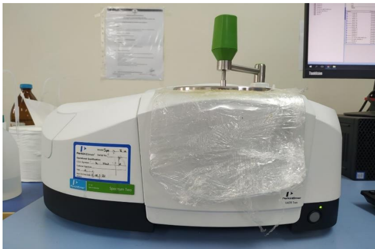
Figure III.49 : Un spectromètre optique « Spectrum two » de PerkinElmer.
