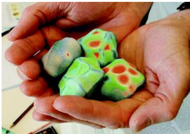
Figure I.11 : Modèles solides des surfaces de Hirshfeld de benzène produit avec une imprimante ZCorp Z510.
