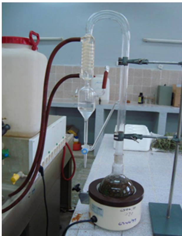
Photo 5: Hydrodistillation des huiles essentielles
