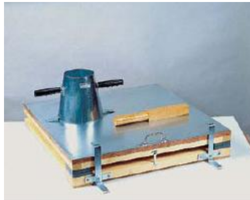
Figure n°42 : Appareil utilisé pour l'essai d'étalement.
