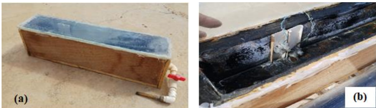
Figure IV.4: Photographie du réservoir supérieur et l'emplacement des détecteurs de niveau.
