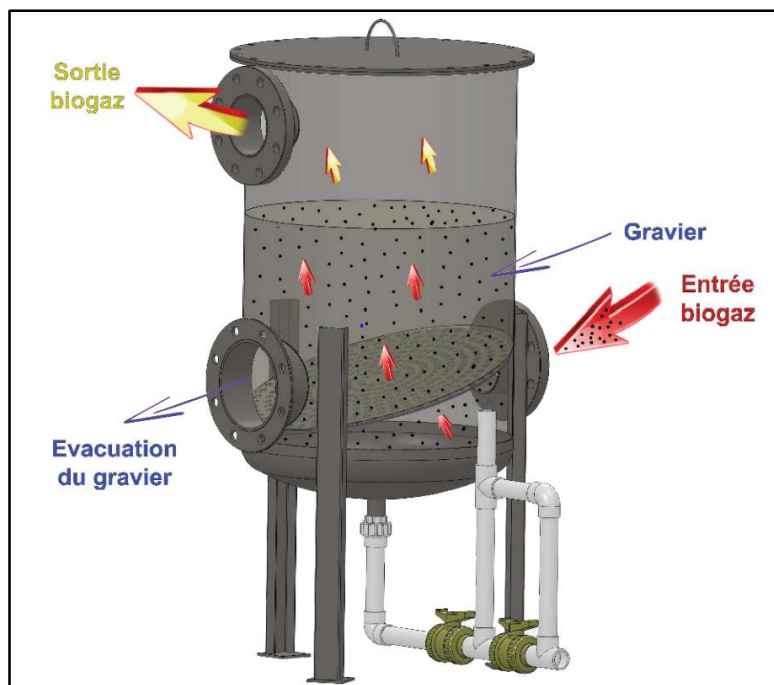
Figure 64 : Le filtre a gravier
