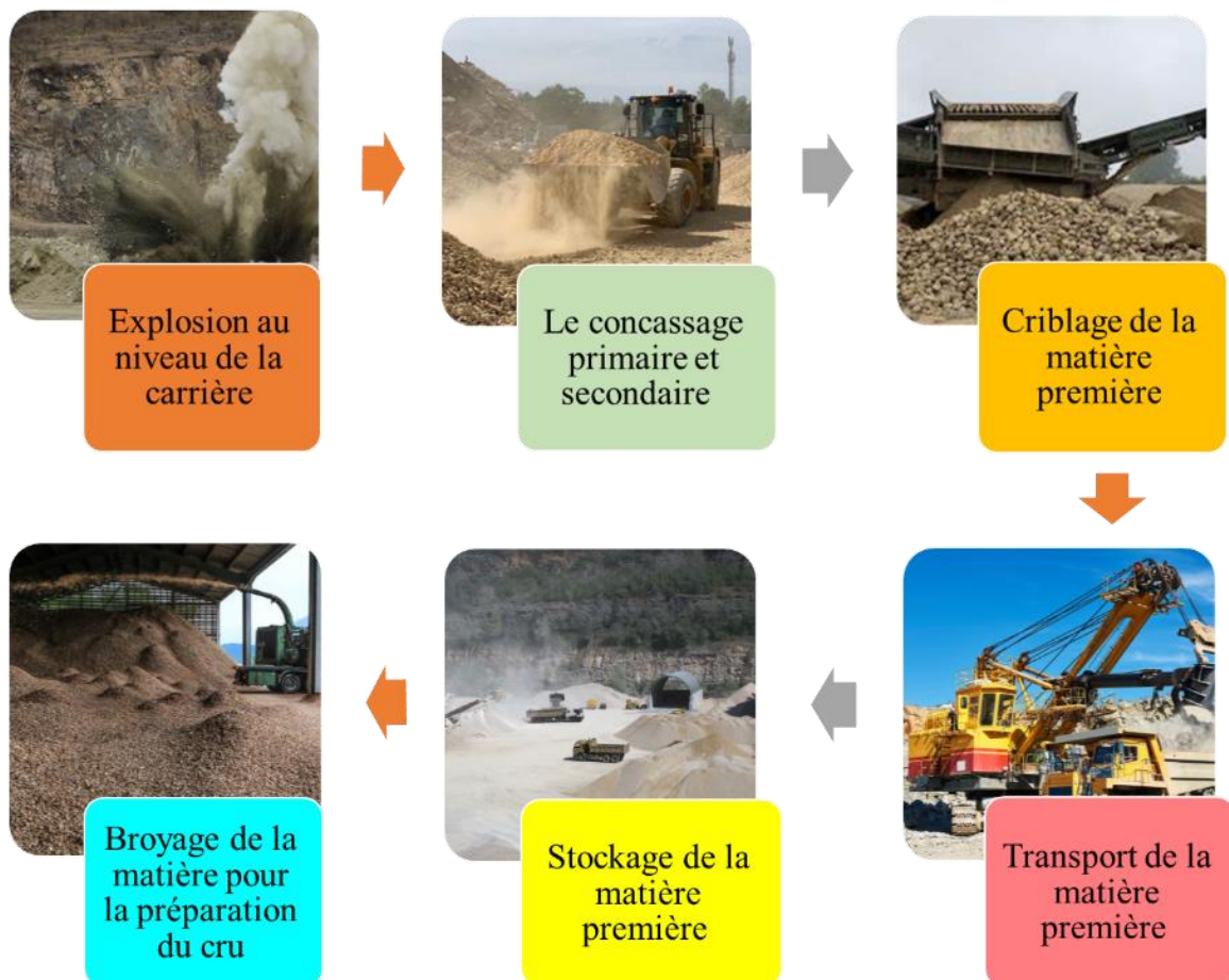
Figure 57 : Processus de la production de matière crue
