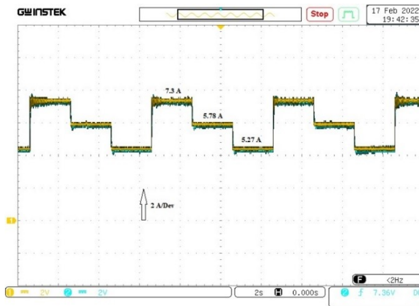
FIGURE 3.23 – Performances de l'EPV, courant de référence et courant mesuré.
