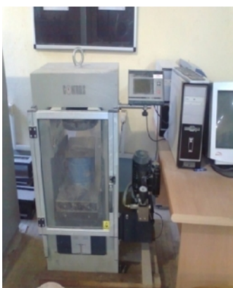
Figure 5.16 : Appareil d'écrasement pour béton.
