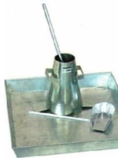
Figure 5.4 : Cône d'Abrams (Slump-test).
