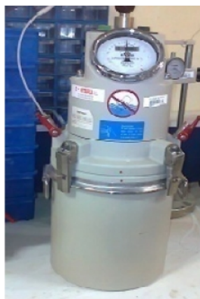
Figure 5.6 : Aréomètre à béton de huit (08) litre.
