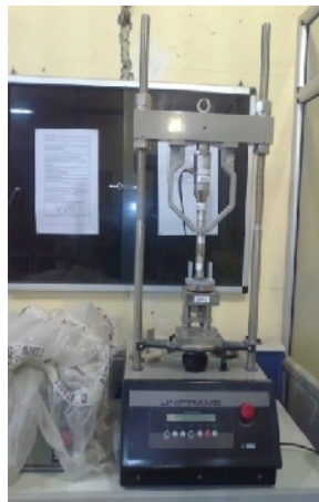
Figure 2.1 : Appareil traction par flexion pour mortier.
