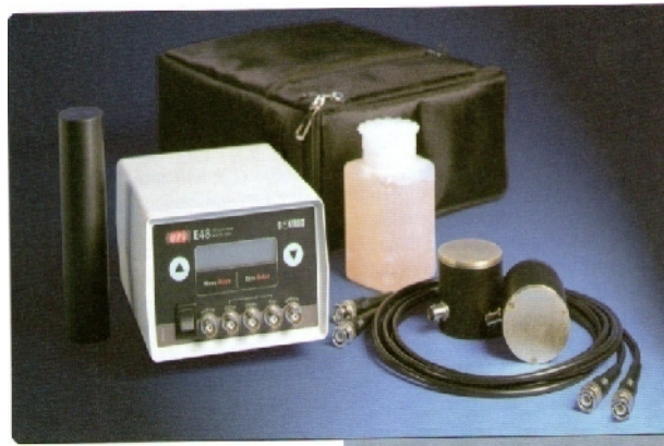
Figure 5.19 : L'appareil d'essai d'auscultation sonore.
