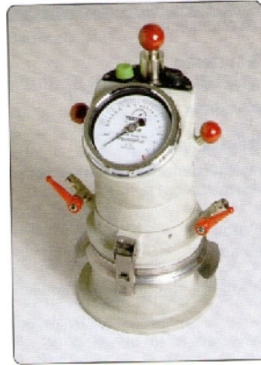
Figure 2.9 : Aréomètre à mortier d'un (01) litre.
