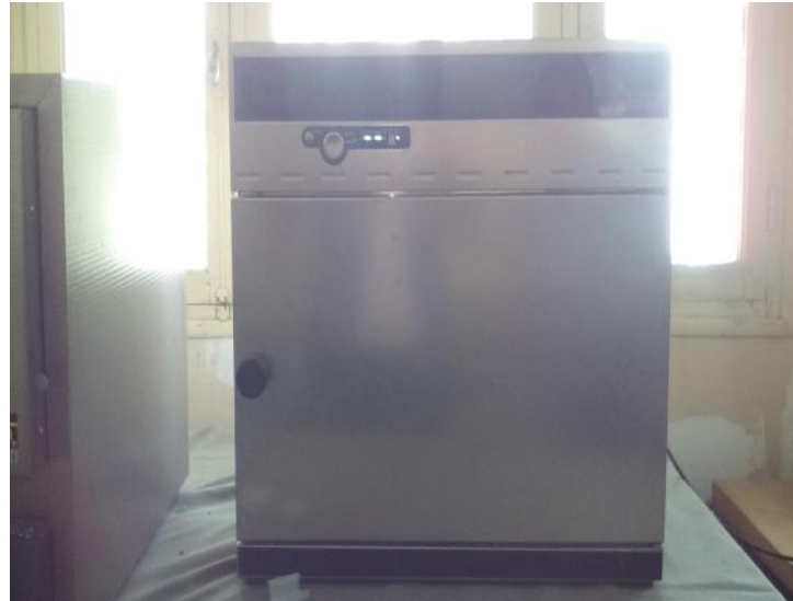
Fig.II.9 : Etuve de marque BINDER utilisé pour le séchage de nos couches.
