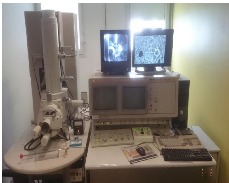
Fig.II.15 : Photos du MEB à effet de champ « JEOL JSM 6301F » (Univ. d' Angers, Angers - France).
