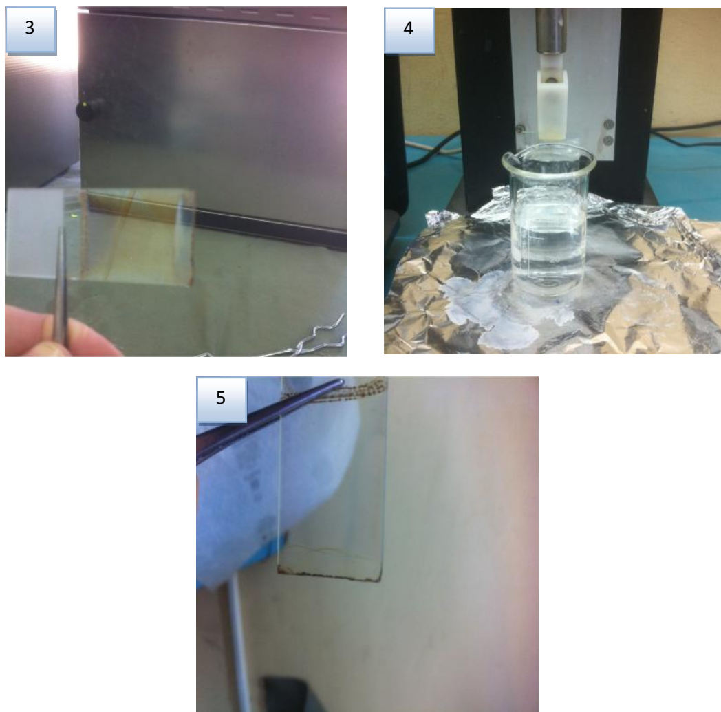
Fig.II.8 : Les différentes étapes de la formation d'une couche mince par la méthode de trempage- tirage : le substrat est situé au dessus du récipient contenant la solution (1), puis il est immergé dans le liquide (2). Après avoir attendu quelques secondes la stabilisation de la surface de la solution, il est procédé à la remontée du substrat (3). Le liquide s'écoule alors uniformément (4). Ce film est formé après l'évaporation des solvants les plus volatils (5).
