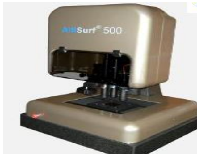
Fig.II.11 : Profilomètre Altisurf 500 utilisé pour la mesure des épaisseurs de nos couches.
