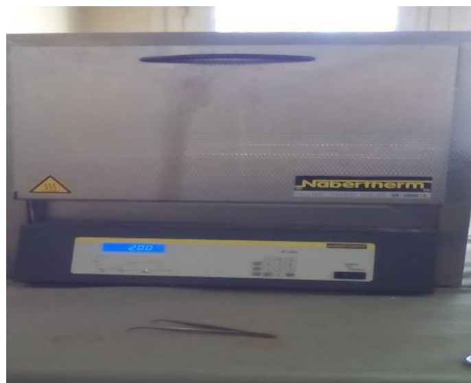
Fig.II.10: Four de marque Nabertherm utilisé pour le recuit de nos couches.
