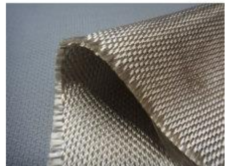
Figure 8: Silice haute HSIF3784 en tissu de fibres
