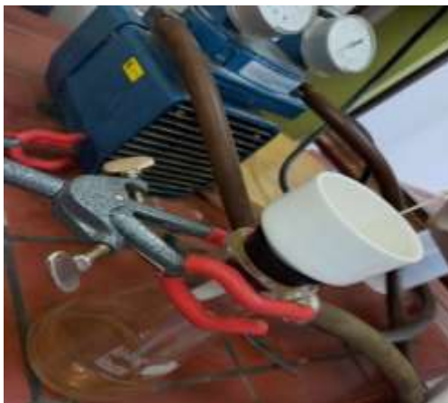
Figure (29) : Montage de filtration sous vide.
