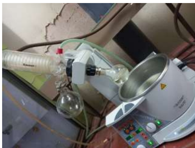
Figure (30) : Montage de l'évaporation.
