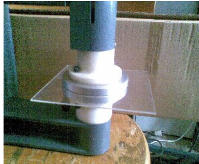
Figure 2.4 : les électrodes usinés sont montés avec les autres éléments du réacteur
