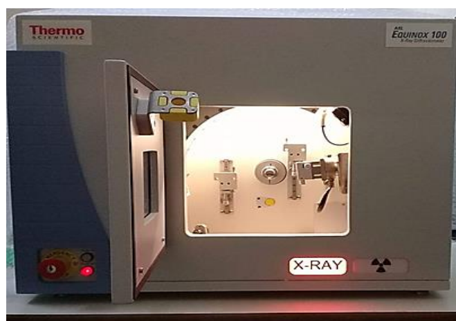
Figure II. 9: appareil de diffraction des rayons X (DRX) « ARL EQUINOX 100 X-Ray Diffractomètre ».
