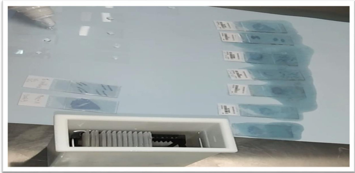
Figure 31 : Montage des lames sélanisées (Khenniche, 2023)
