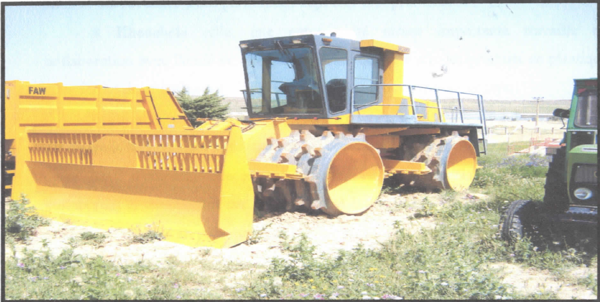
Photo N° 03 :ENGIN DE COMPACTAGE
