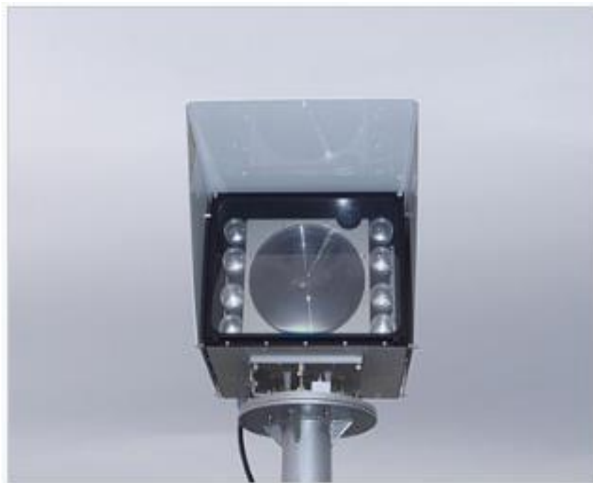
Figure 1 : Laser optique 8 faisceaux en espace libre, assurant un lien de débit 1Gbits/s à une distance approximative de 2 km. Le récepteur est constitué du large disque central, l'émetteur des 8 petits disques latéraux. En haut à droite, un objectif monoculaire d'assistance à l'alignement des deux têtes laser.
