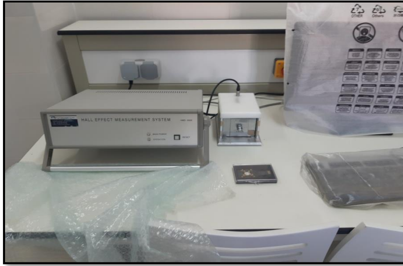
Figure II.22: Système de mesure à effet Hall de type: Ecopia HMS-3000.
