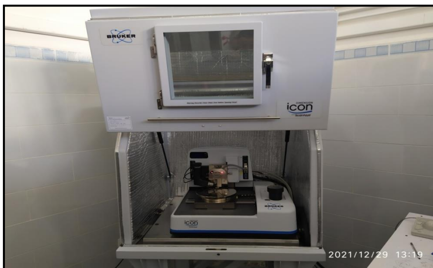
Figure II.17: Photographie de l'appareil : Microscope à Force Atomique «ICON».
