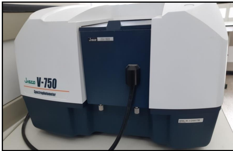
Figure II.19: Spectrophotomètre UV-visible de type «Jasco V-750».
