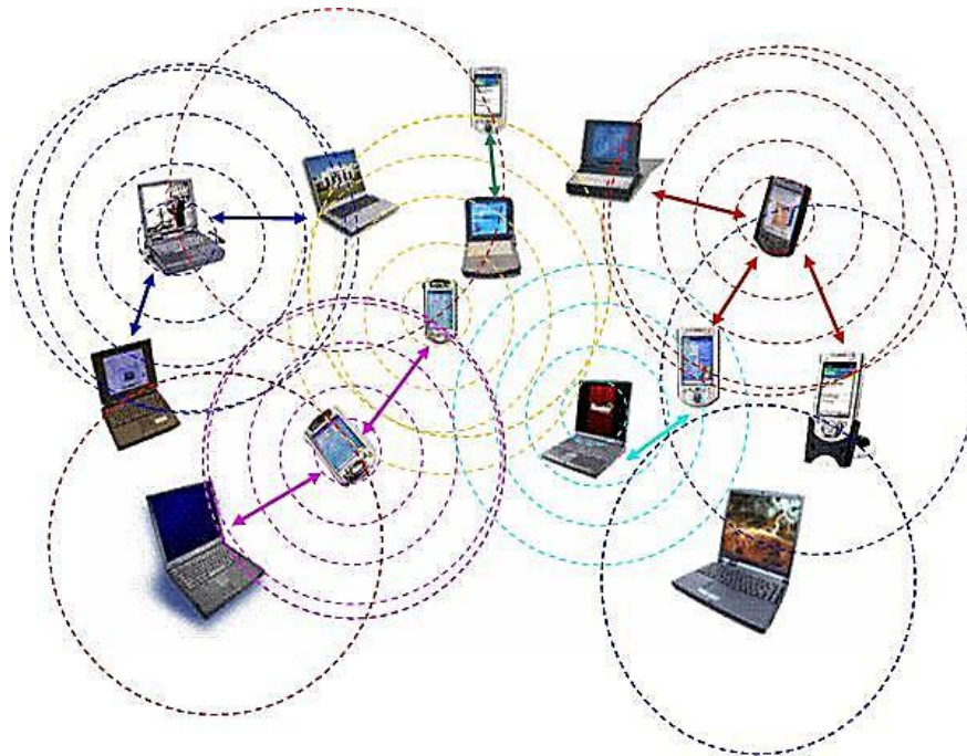
Figure 1.1 Réseau Ad hoc
