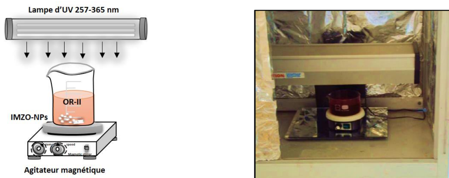
Figure IV.3. Images photographiques montrent le montage expérimental d'évaluation photocatalytique des NPs de ZnO, sous irradiation d'UV.
