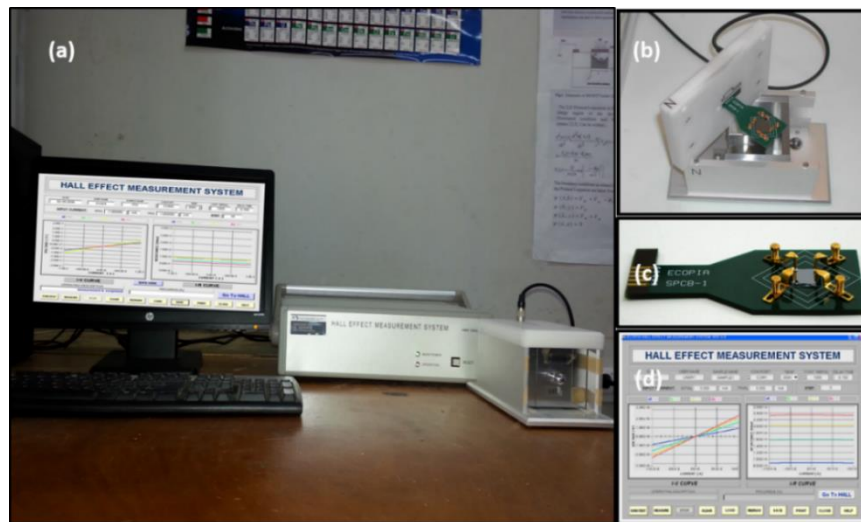
Figure II.29. (a) : Montage expérimental de l'effet Hall se compose de : (b) Ensemble d'aimants et cryostat avec densité de flux magnétique de 0.55T et 1.0T, (c) La carte à clipser Spring SPCB-1 comme un support d'échantillon, et (d) : logiciel.
