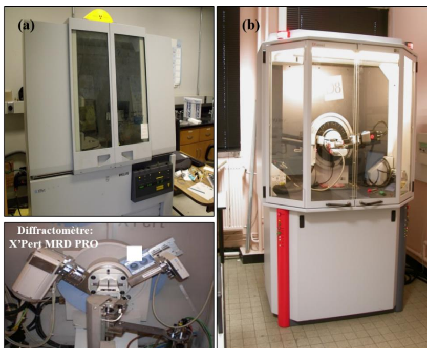
Figure II.14. (a) : Photographie du diffractomètre de Philips PANanalytical X'Pert MRD/PRO et (b) : Photographie du diffractomètre de Bruker AXS-8D Discover.
