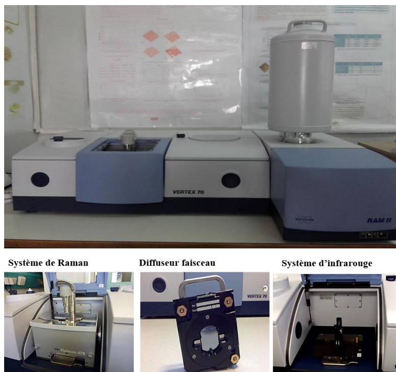
Figure II.16. Photographie du spectromètre de transformation de Fourier infrarouge Vertex 70 avec le module RAM II Bruker et ces accessoires.
