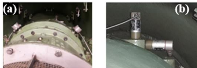
Figure 4.2 : Positionnement des capteurs : (a) Capteurs de proximité; (b) Capteurs d'accéléromètres
