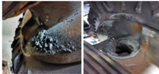
Figure 4.23 : Déformation du trou de l'arbre sous l'effet d'un point chaud
