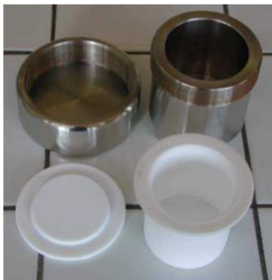
Figure V.1 : Photographie du corps du réacteur en acier et de sa chemise en Téflon®. Les dimensions internes du réacteur sont h=55\text{mm} et \varnothing=55\text{mm} .
