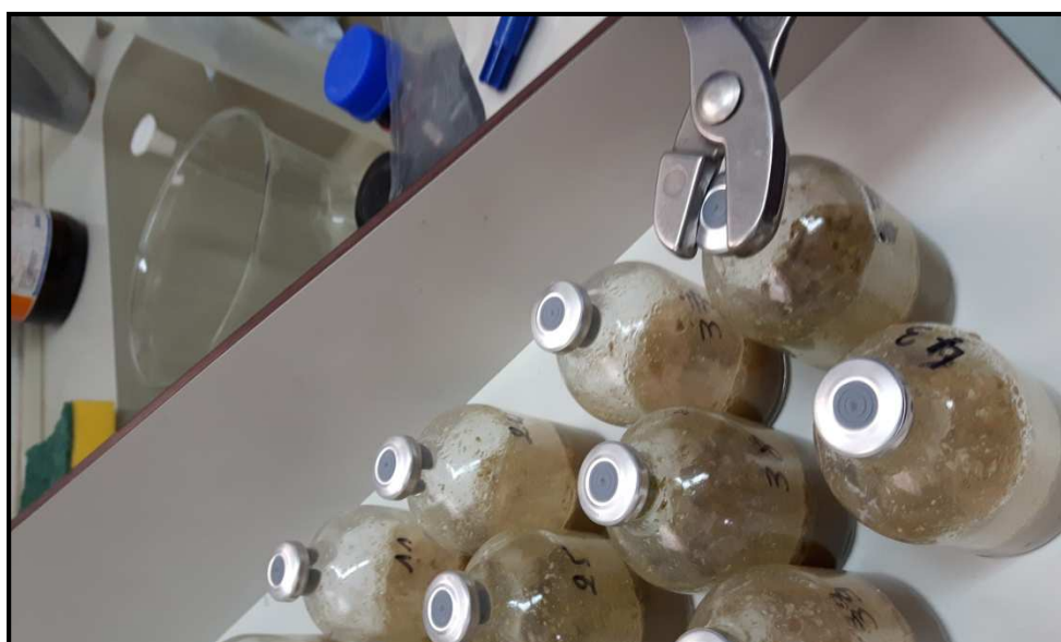
Figure 22. Système de fermentation en batch (flacons Wheathon).
