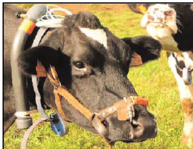
Coffre de tête ou capuche du calorimètre.
