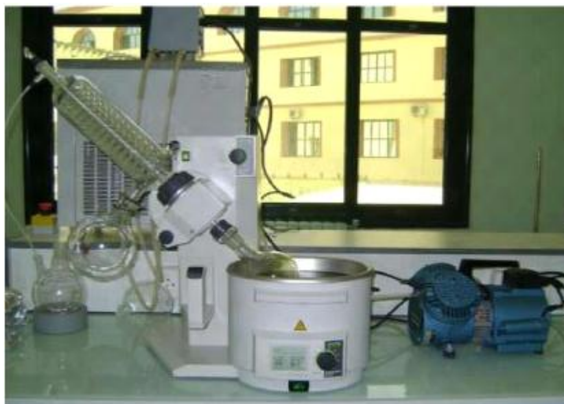
Figure 28: Evaporation des extraits par Rotavapor (R-210 BUCHI).
