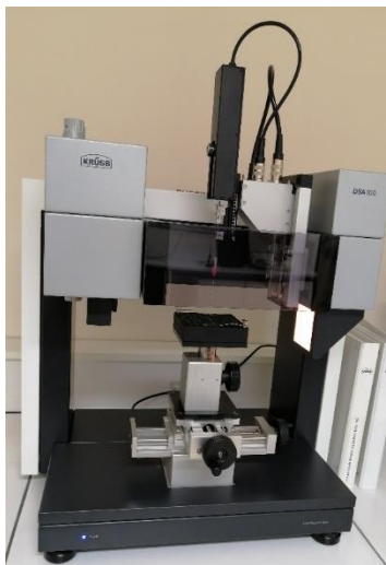
Figure II.9 : Appareil de mesure d'angle de contact Krüss DSA100.
