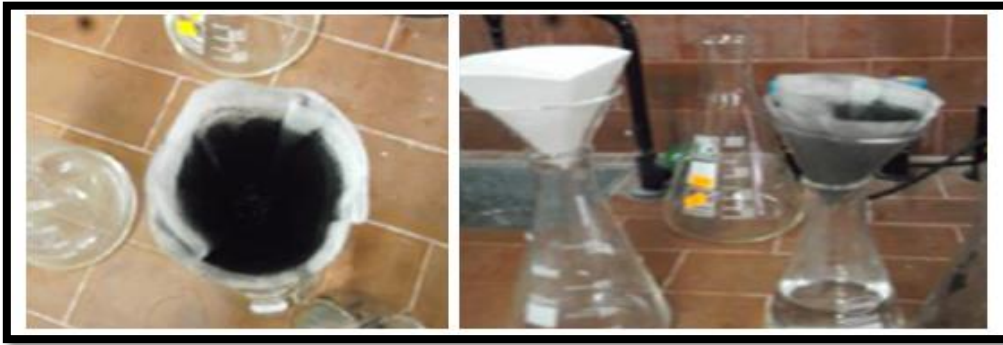
Figure III.1.14: Opérations de lavage et séchage du charbon actif.
