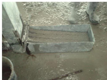
Photo III. 7: La boîte en L utilisée.
