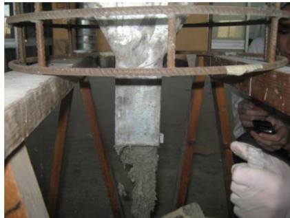
Photo III. 8: V funnel utilisé.
