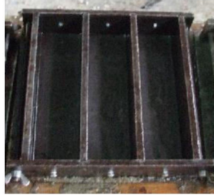
Photo III. 14: Eprouvettes prismatiques 7x7x28cm
