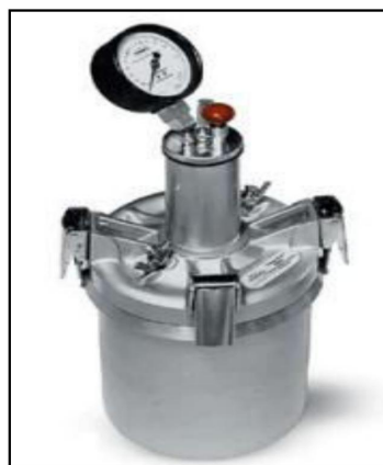
Figure I. 16: Mesure de l'air occlus à laide d'un aéromètre.
