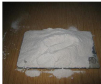
Photo III. 2: Le déchet de marbre utilisé.
