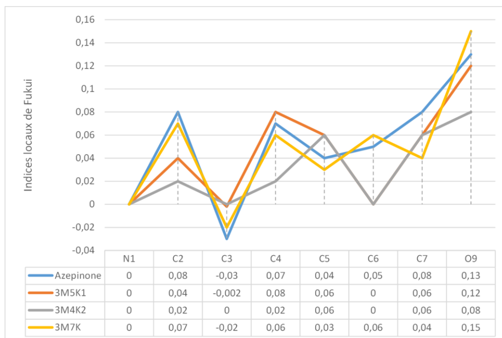
Figure 61. Indices de Fukui ( f^+ ) calculés aux centres réactifs du cycle 3-chloro-azépinone substitué par le groupement amine.
