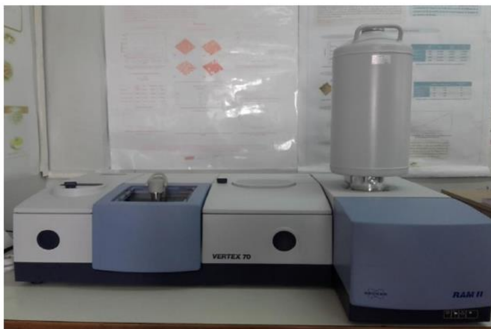
Figure III.15: Photographie du spectromètre de transformation de Fourier infrarouge Vertex 70 avec le module RAM II Bruker.
