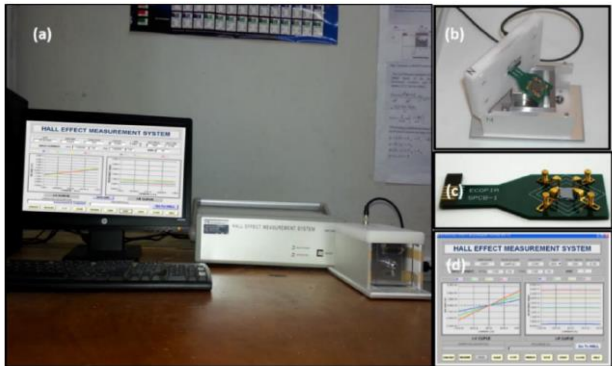
Figure III.18: (a) : Montage expérimental de l'effet Hall se compose de : (b) Ensemble d'aimants et cryostat avec densité de flux magnétique de 0.55T et 1.0T, (c) La carte à clipser Spring SPCB-1 comme un support d'échantillon, et (d) : logiciel.
