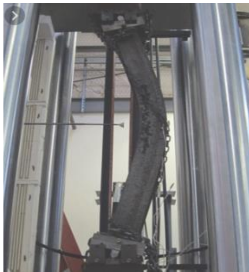
Figure 02 : Essai de flambement pour colonne métallique. Réf [4].
