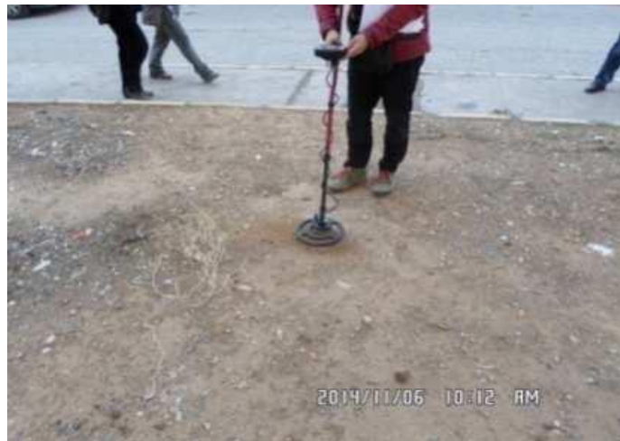
Figure. 3 : Photo de l'utilisation de détecteur de métaux
