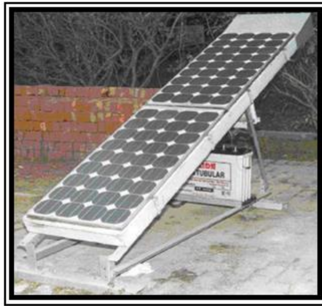
Figure 3.9 : Banc d'essai du capteur solaire hybride PVT à air [112].
