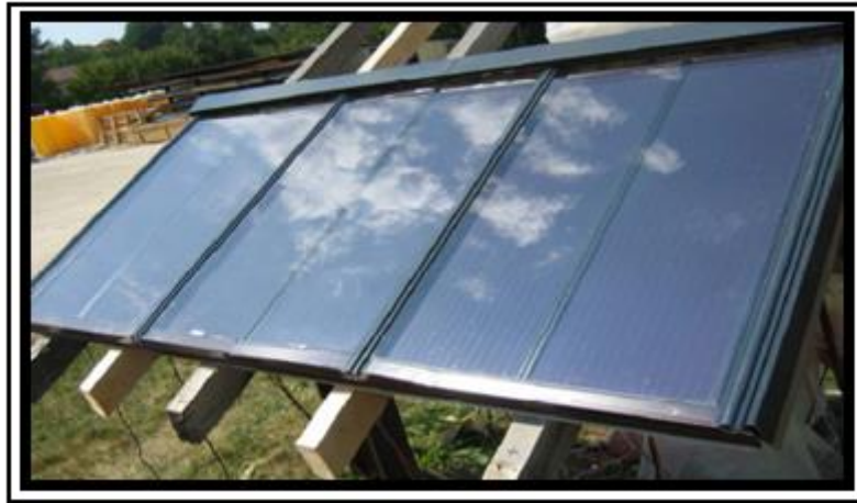
Figure 3.18 : Le capteur solaire PV/T hybride à eau [90].
