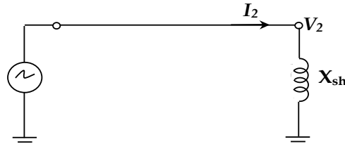
Figure.4.9. Compensation shunt par inductance
