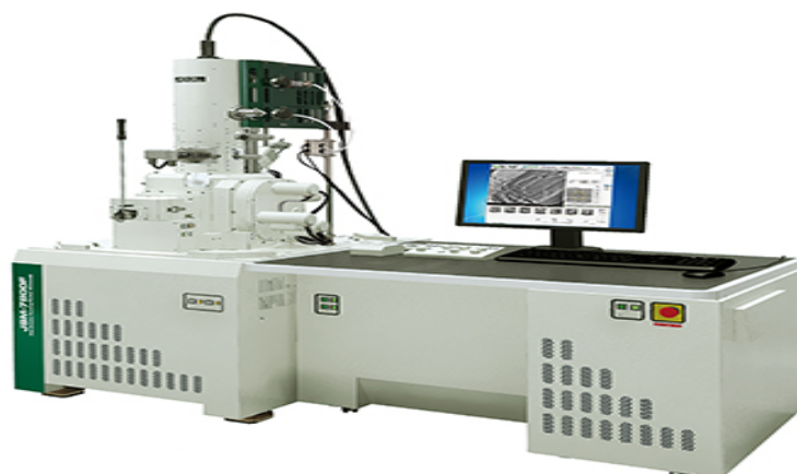
Figure II.11 : Microscopie électronique à balayage de type JSM-7800F.
