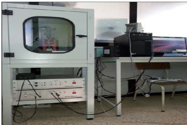
Figure II.13 : Photographie du microscope à force atomique de type A.P.E. Research-A100 de laboratoire LCAM, université d'oum El Bouaghi.
