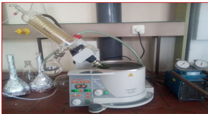
Figure 21. Photo de rotavapeur utilisé pour concentrer sous vide les différents extraits des plantes.
