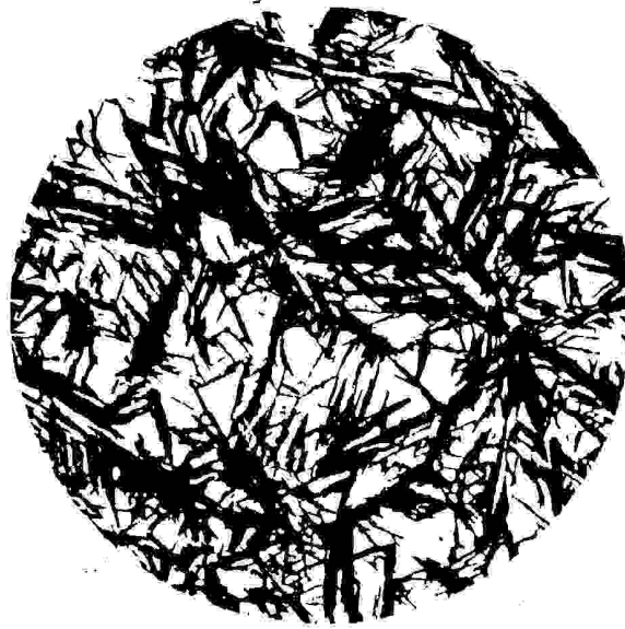
Figure 2-23 : Structure ; Martensite cubique grossière +austénite.[19]
