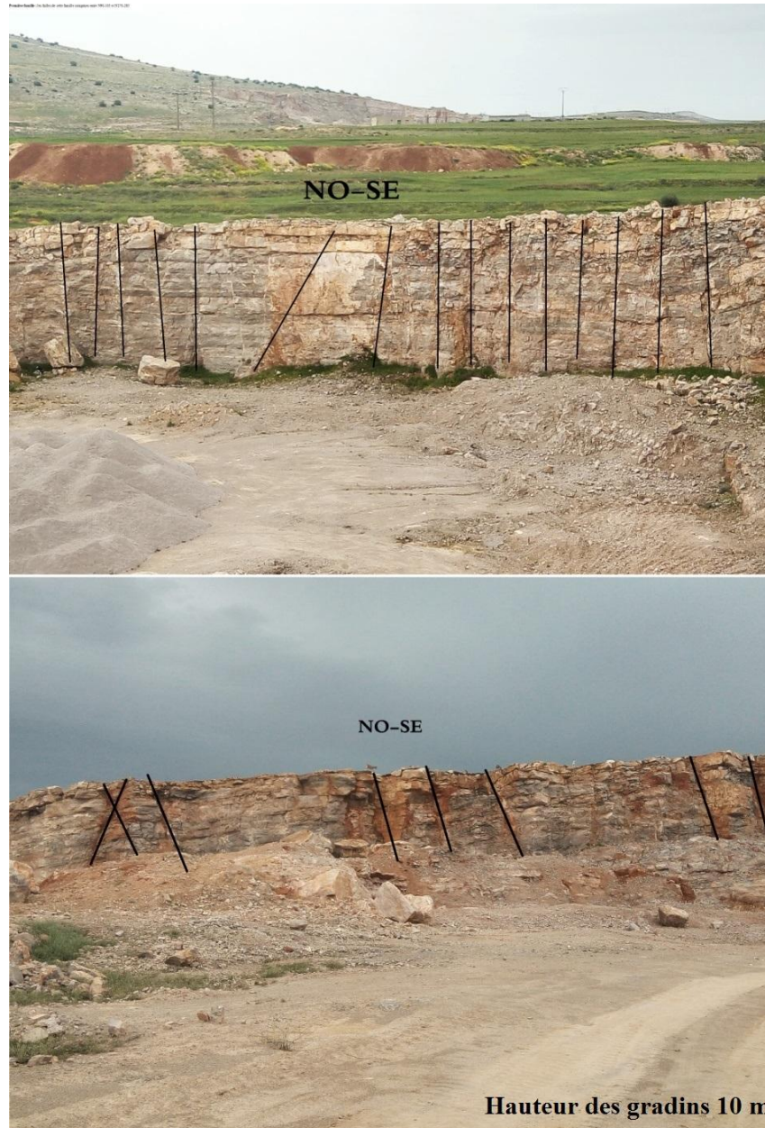
Photo.3 : Famille de failles de directions NO-SE au niveau de Djebel Felten
