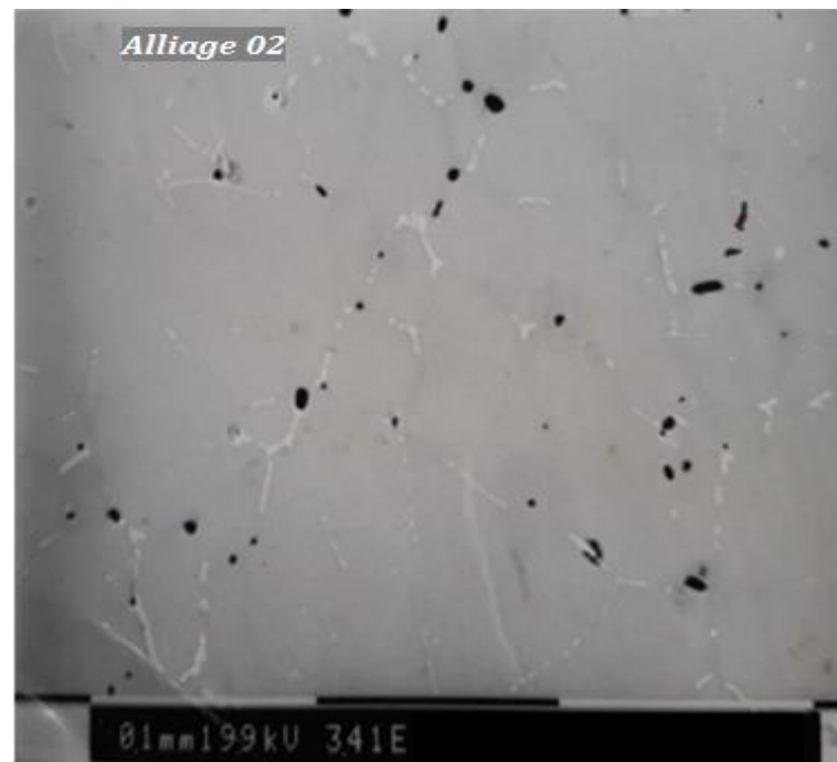
Figure V.6 Mirostructure obtenue par le MEB de l'alliage 02 homogénéisé à 530°C Pendant 15 min et trempé à l'eau froide puis vieilli à 175°C pendant 10 heures.
