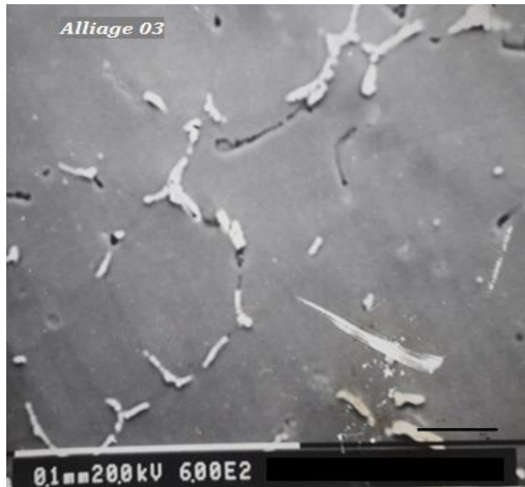
Figure V.7 Mirostructure obtenue par le MEB de l'alliage 03 homogénéisé à 530°C pendant 15 min et trempé à l'eau froide puis vieilli à 175°C pendant 10 heures.
