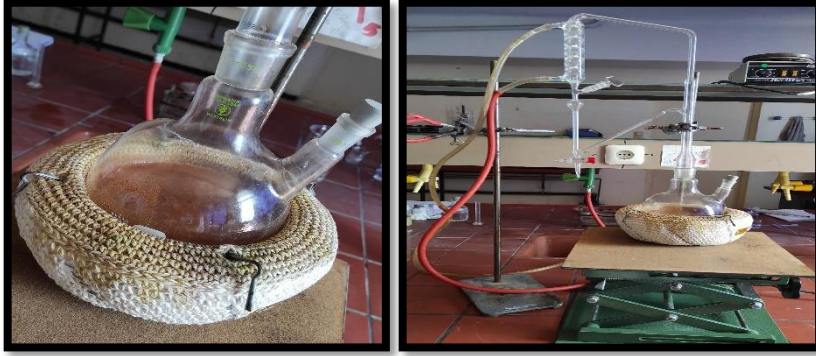
الشكل 19: استخلاص الزيوت الأساسية من نباتي ( Pimpinella anisum ) و ( Illicium verum ) بواسطة جهاز التقطير المائي
