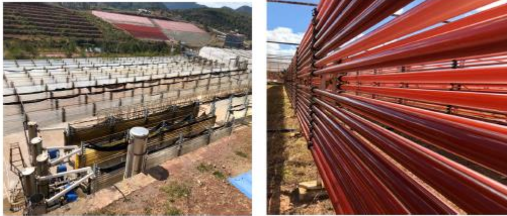
Figure 8 : Installation de production d'algues en bioréacteur à tube fermé dans la province de Yunnan, en Chine (Balasubramaniam et al., 2021).
