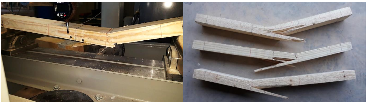
Figure 4.14: Les poutrelles de bois après le test de flexion.
