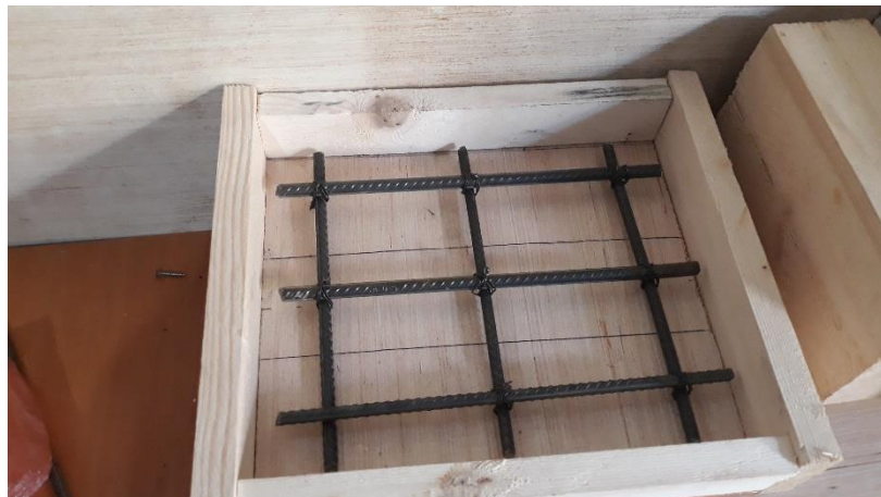
Figure A.17: Coffrage de béton de spécimen mixte avant découper l'entaille
