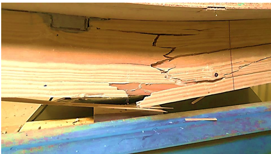
Figure 5.16: Rupture finale : traction par flexion du bois dans la poutre B+INC.
