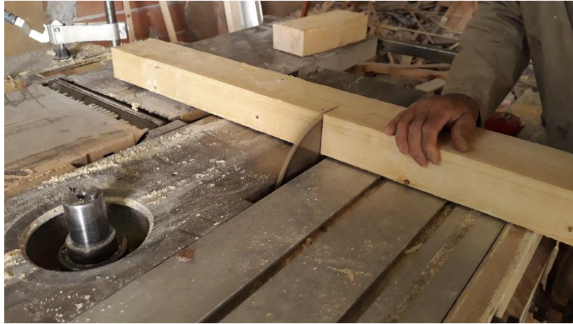
Figure A.11: Sciage des poutres pour former les tronçons en bois pour les spécimens composites de push-out.
