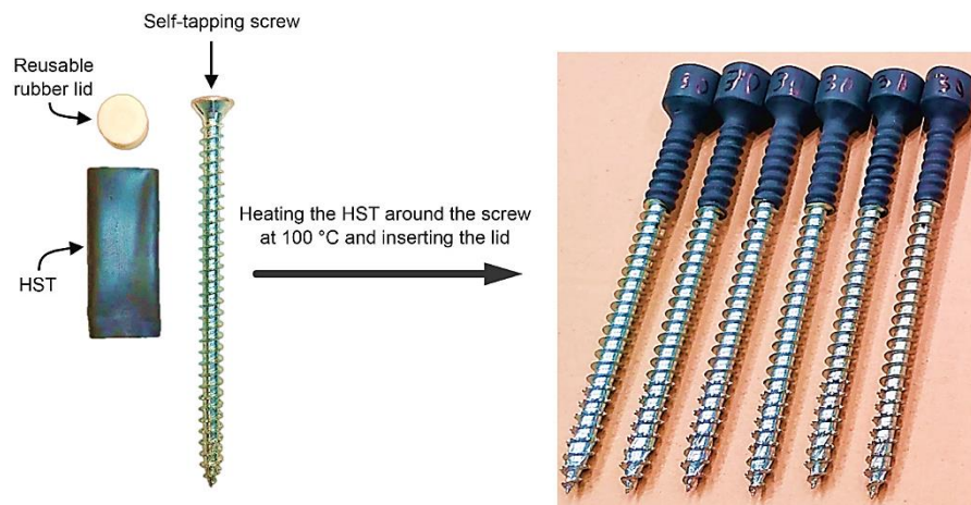
Figure 2.38: Connecteurs déconstructibles à l'aide de vis autotaraudeuses : composants individuels, processus de production et configuration finale [31].
