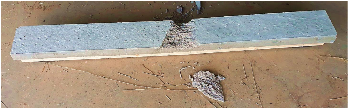
Figure 5.23: Détachement de béton entre les rotules de vérin de la zone comprimée à mi-travée de la poutre mixte S+s.
