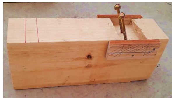
Figure 4.9: Connexion rectangulaire renforcée par 2 vis (R 50+2 vis)
