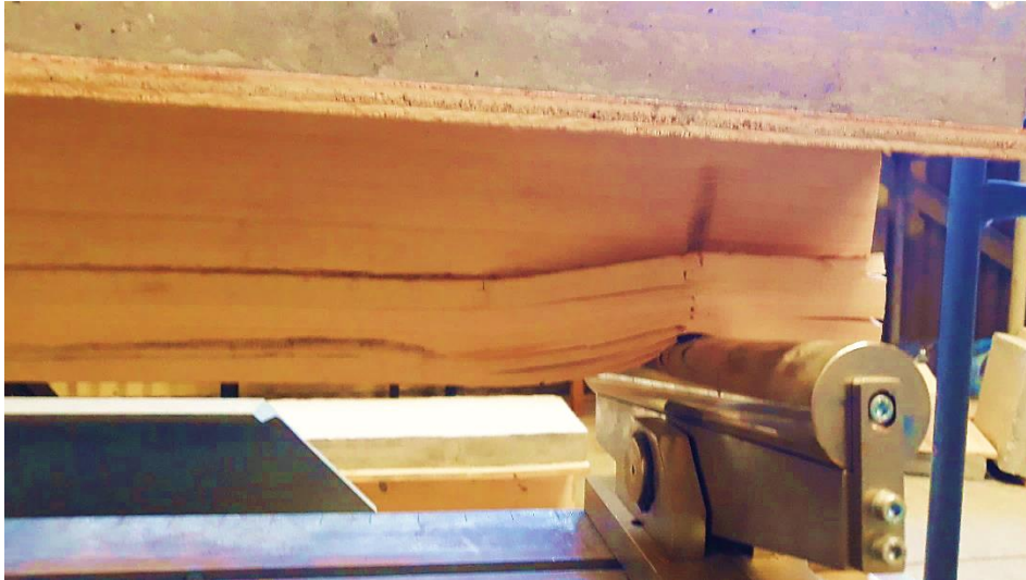
Figure 5.21: Rupture par écrasement de bois sur les appuis de la poutre B+s.
