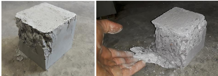
Figure 4.12: éprouvette cubique après le test d'écrasement
