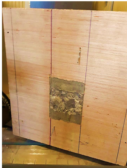
Figure 4.24: Plan de cisaillement de connexion R-50 sans renforcement.
