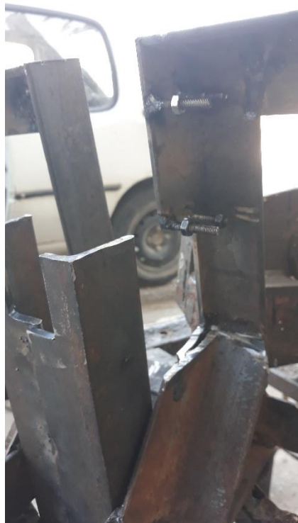
Figure A.7: Espace de mesure de glissement et installation de capteur digital de déplacement.
