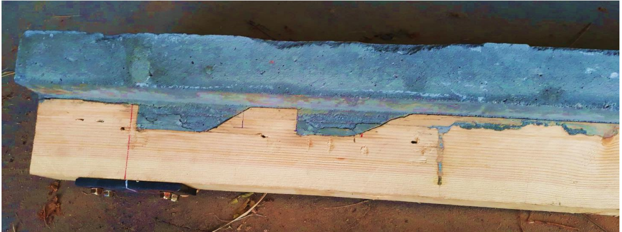
Figure 5.28: La deuxième extrémité de la poutre mixte reste intacte.
