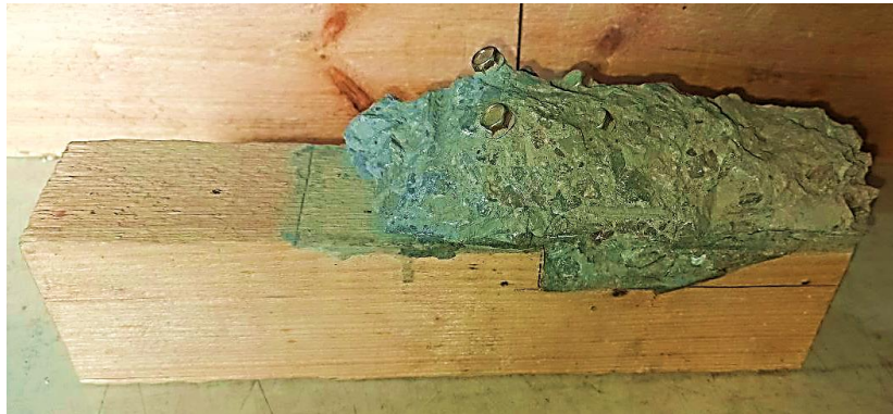
Figure 4.30: Arrachement de bloc de béton de la connexion TRZ.
