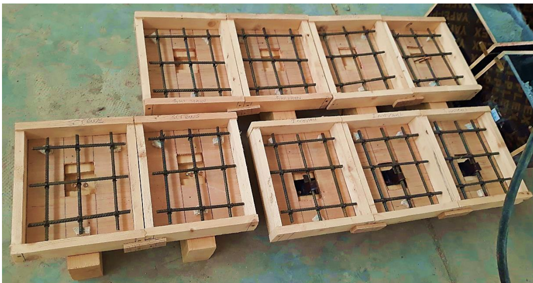
Figure 4.7: Les spécimens de Push-out avant le coulage de béton.
