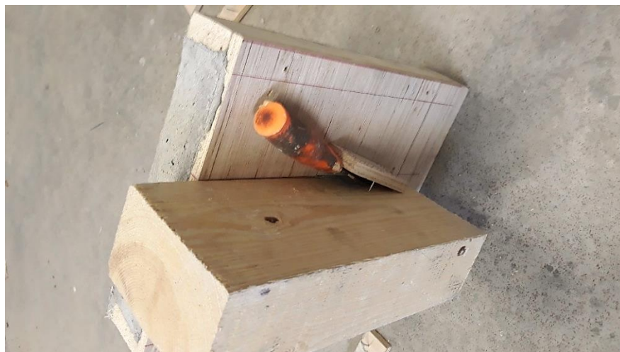
Figure A.21: Décoffrage de spécimen mixte avant les placer dans le support porteur pour le test de push-out
