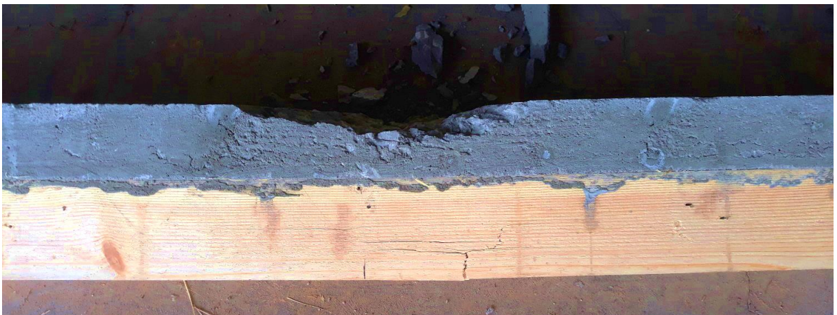
Figure 5.24: Détachement de la zone comprimée entre les rotules de chargement instantanément avec la rupture par traction de la poutre en bois.
