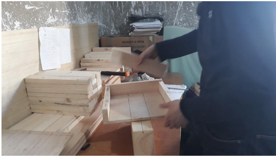
Figure A.16: préparation du coffrage des spécimens mixtes
