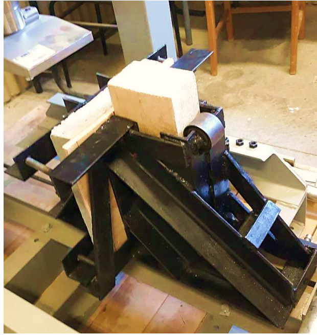
Figure 4.6: Spécimen composite maintenu dans le support prêt pour le test de « push-out ».
