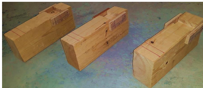
Figure 4.3: Tronçons de bois destinés aux spécimens mixtes de la connexion rectangulaire sans renforcement.
