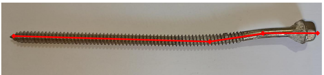
Figure 4.26: Formation de deux points de déflexion plastique sur les deux vis de renforcement de la connexion R+2 vis.
