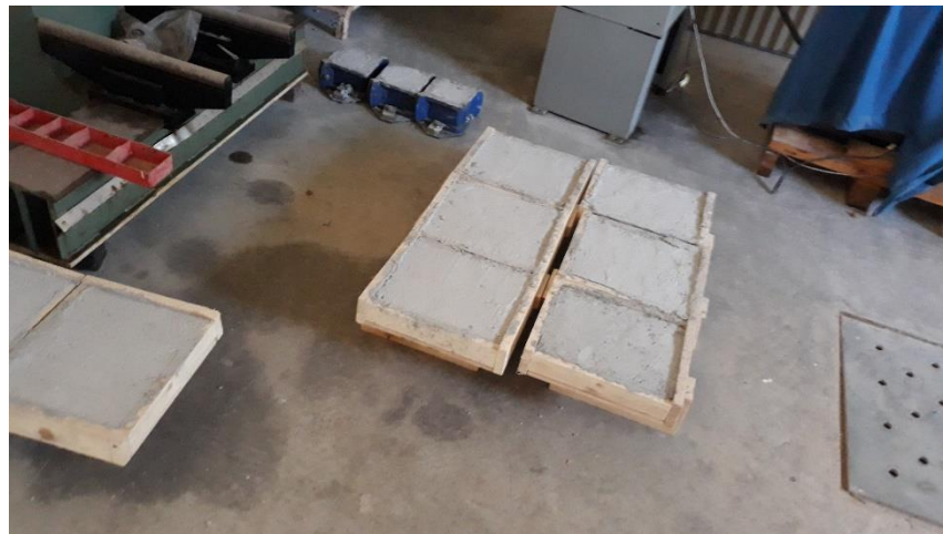
Figure A.20: Les spécimens mixtes avant décoffrage.
